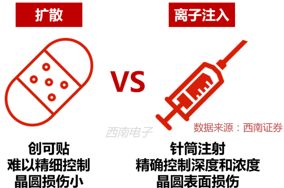
扩散技术和离子注入效果对比示意图
