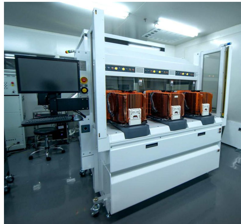
TFX3000 OCD--300mm全自动光学关键尺寸和形貌测量系统
