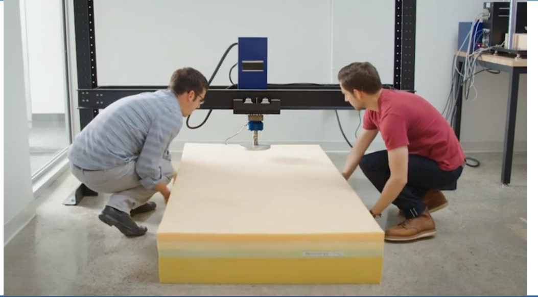
图 12: 工程师在对 Casper 床垫做实验室压力测试
