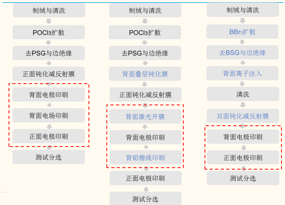
图表 34：双面电池与常规电池工艺对比
