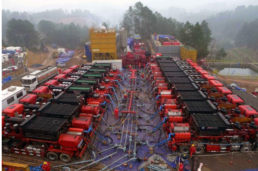
图表 23. 压裂设备的部署现场
