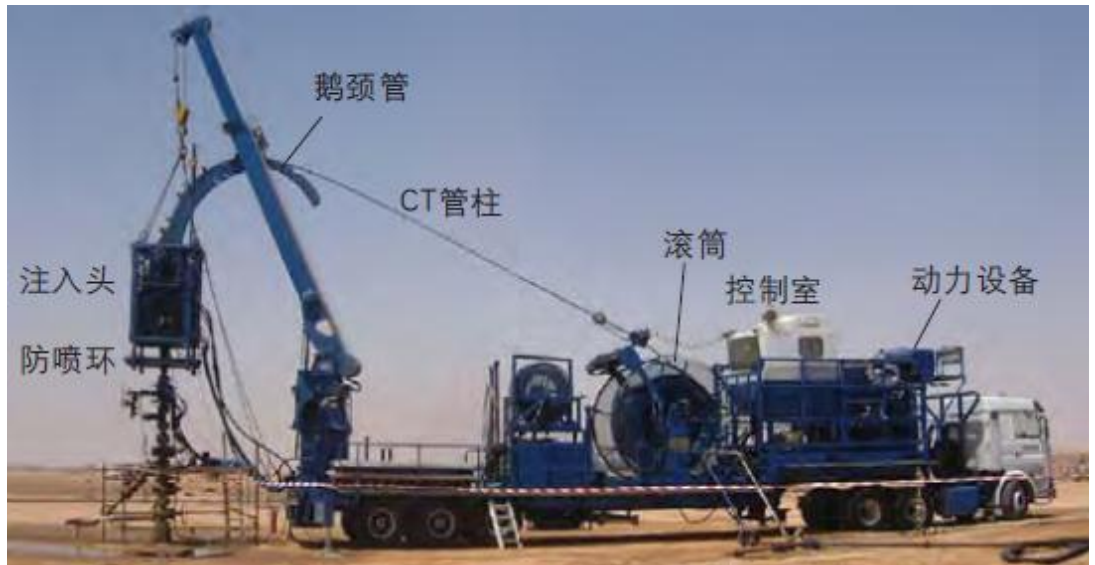
图表 25. 连续油管的部件构成
