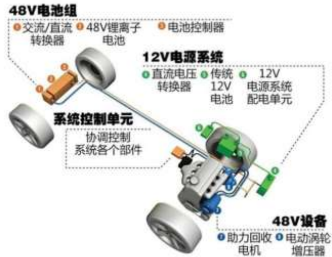
图 10: 搭载 48V 微混系统的汽车示意图
