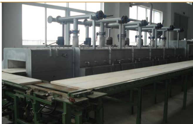
图 13：推板窑推进物料靠在平板上直接推动
