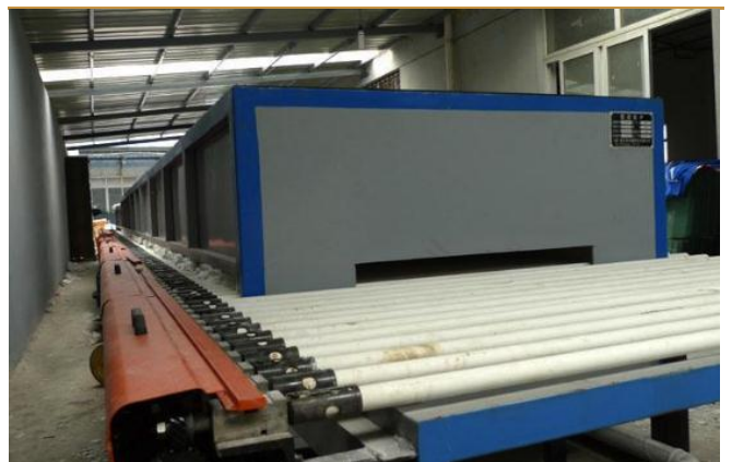
图 14：辊道窑传输物料靠滚筒滚动
