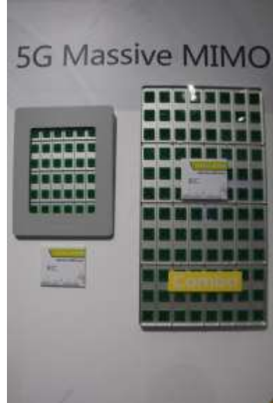
图 31: 京信通信 5G Massive MIMO 天线
