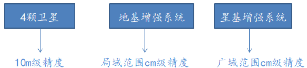
图 2：不同定位方式对应不同定位精度
