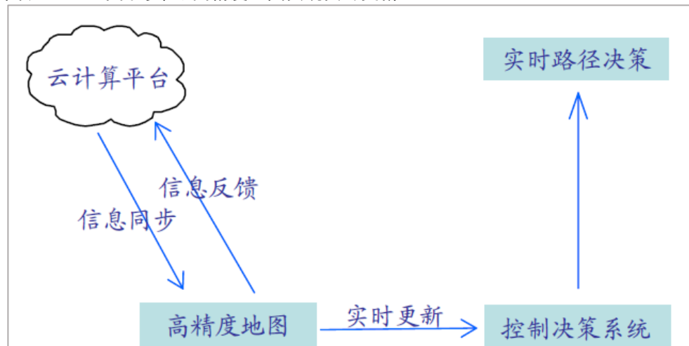
图表 11 云平台可帮助高精度地图实现实时更新
