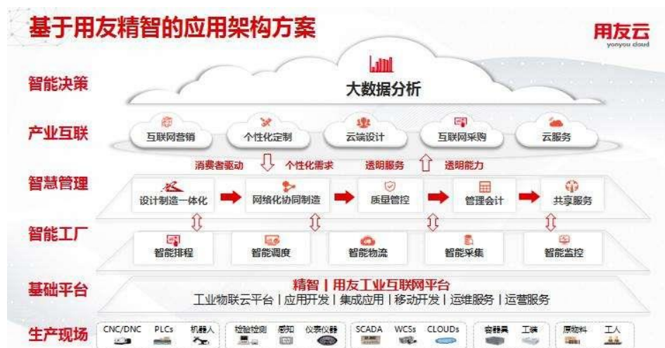
图 29：用友精智应用架构：设备物联与业务系统互联相互融合，支撑智能决策
