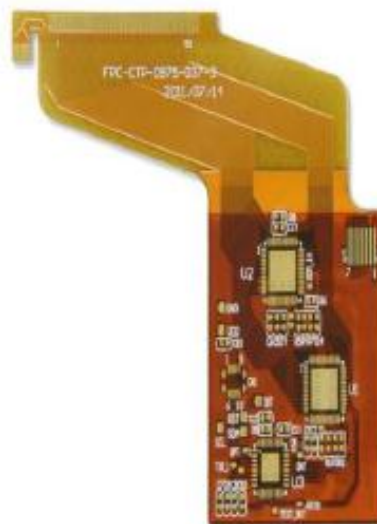
图表 2：柔性电路板的基材为柔性材料
