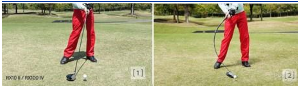
图 13：果冻效应干扰了成像效果，需要利用高速 CMOS 传感器
