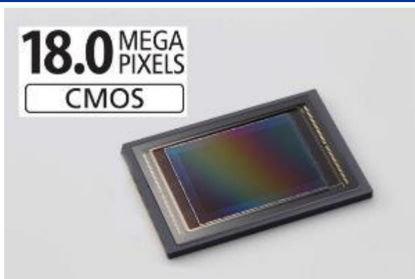
图 3：佳能相机中的 1800 万像素 CMOS 传感器
