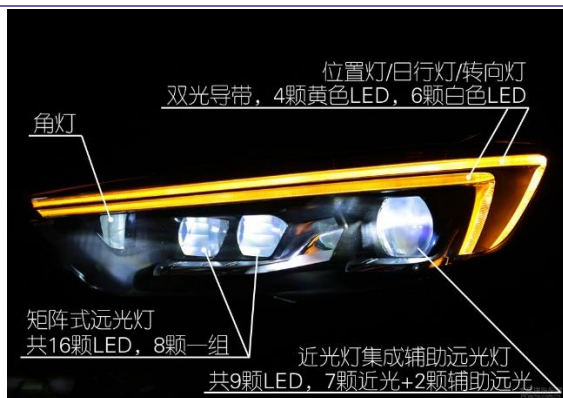
图表 27: 新一代别克君威矩阵式 LED 大灯构成
