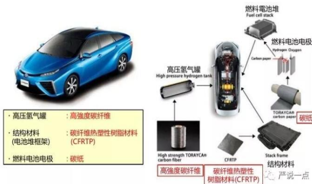
图 39：日本丰田 Mirai 碳纤维使用情况
