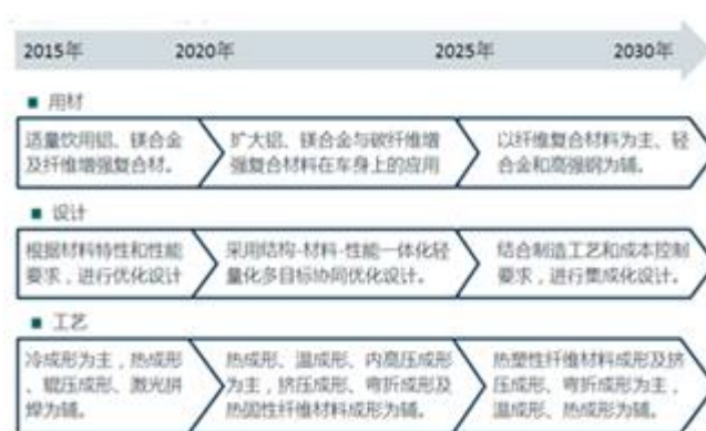
图 17：我国汽车轻量化材料发展路径
