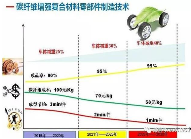
图 19：碳纤维复合材料零部件成本下降趋势
