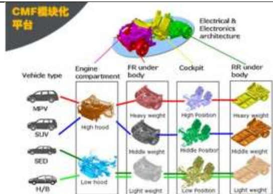
图 45: 雷诺-日产 CMF 模块化平台
