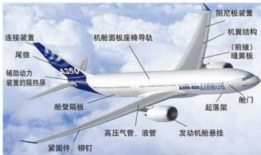
图10：钛合金在飞机上主要应用部位和部件
