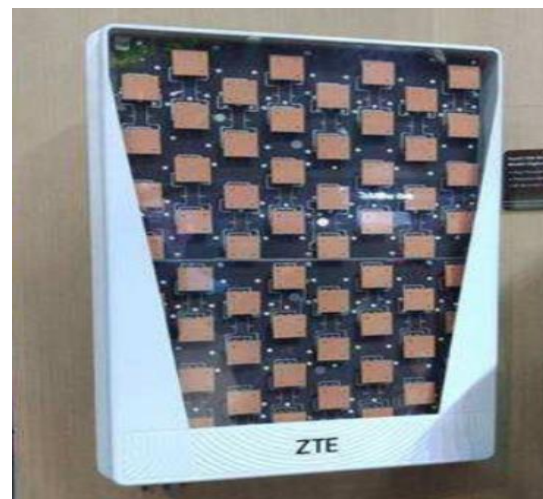
图：中兴64T64R的5G基站天线实物（尺寸约0.8m*0.4m）
