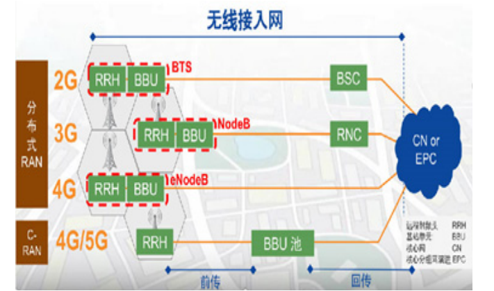
图 7：移动通信无线接入网结构的演进
