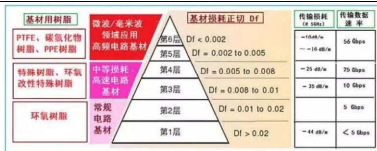
图 36: 毫米波对于板材的要求非常高
