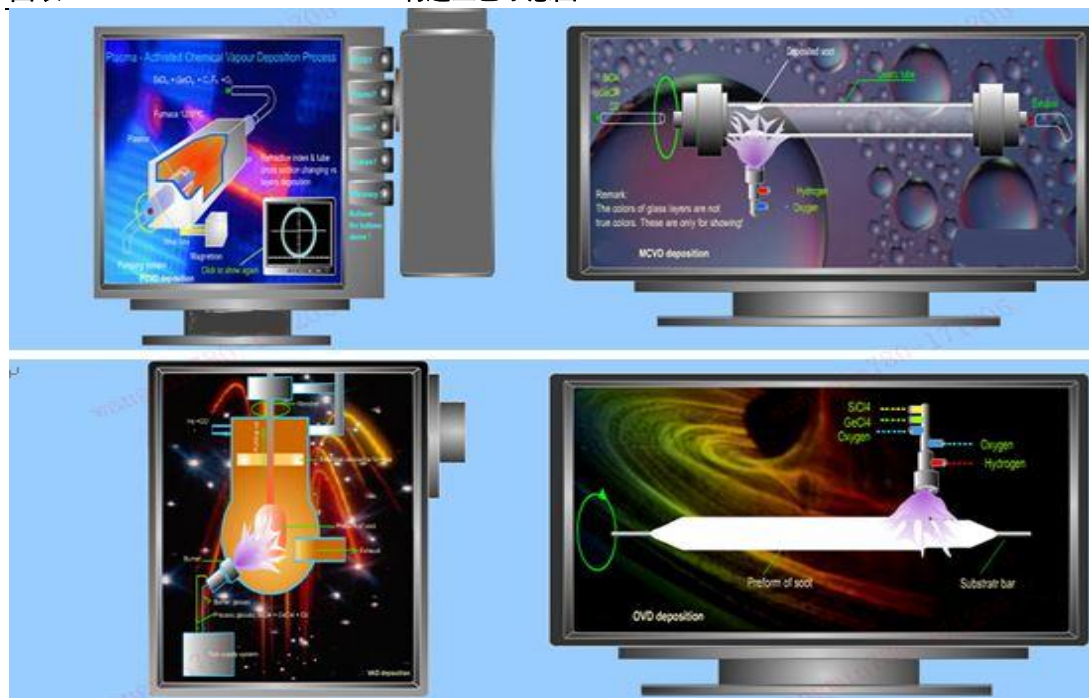
图表43 PCVD/MCVD/VAD/OVD 制造工艺示意图
