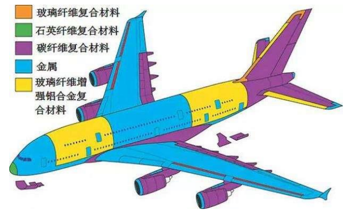
图 107：空客 A380 碳纤维复合材料使用情况
