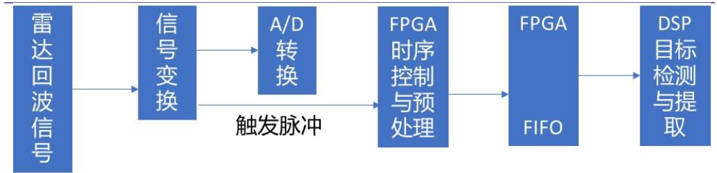
图表 81：雷达系统的信号采集系统
