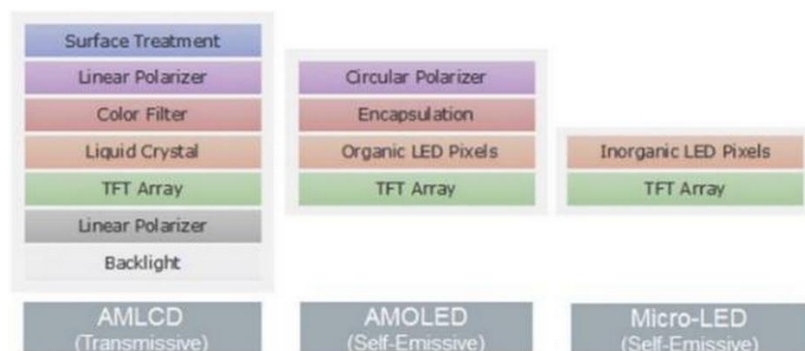
图表 137: LCD、OLED、Micro-LED 器件结构比较
