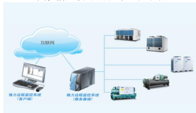
图：格力中央空调远程监控系统
