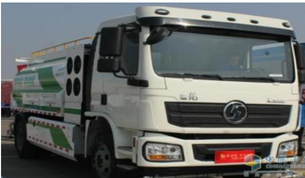
图表19 陕汽德龙 L3000 燃料电池洒水车
