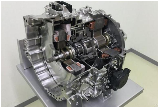
图表5 丰田混合动力驱动桥
