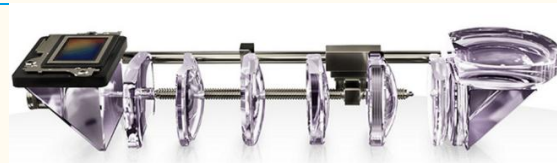
图表 27：Zenfone Zoom 真光学变焦摄像头内部结构
