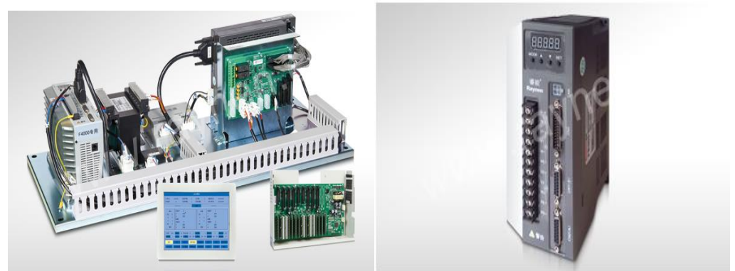
图表37： 公司 F4000 针织横机电控系统、FS300 横机专用全数字式双轴伺服驱动器
