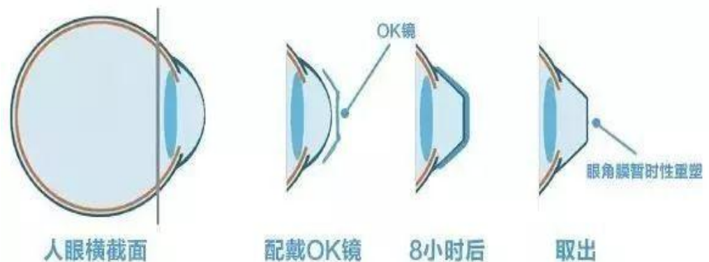
图 3: 角膜塑形镜原理
