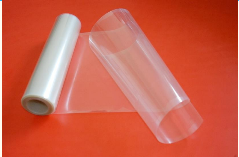
图表 5：东岳集团全氟磷酸质子膜示意图
