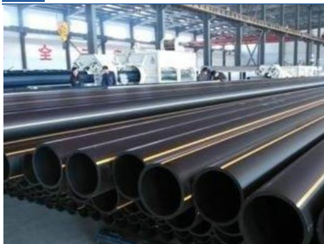
图 20: 天然气 PE 管
