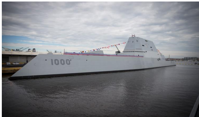
图表29: 美国 DDG1000 驱逐舰上层建筑使用了复合材料
