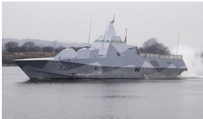
图表28: 瑞典维斯比级护卫舰舰体使用了复合材料
