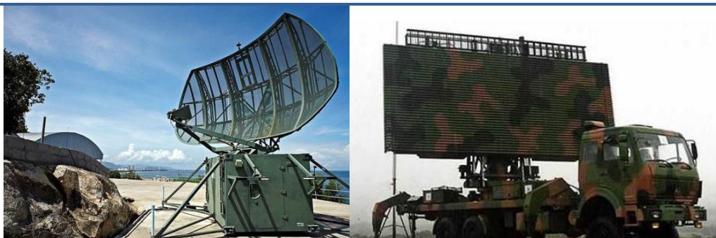
图 7：机械扫描雷达（左）与相控阵雷达（右）
