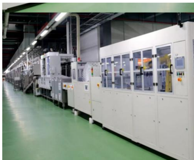
图 3. 景旺江西二期电镀线实现自动化
