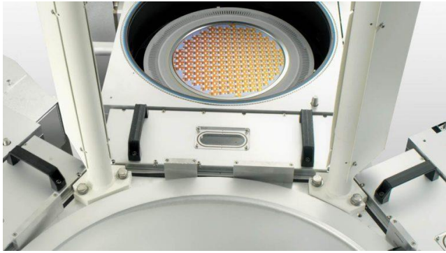
图表163: 拉姆研究采用 ALE 技术的 FLEX 系列介质刻蚀产品
