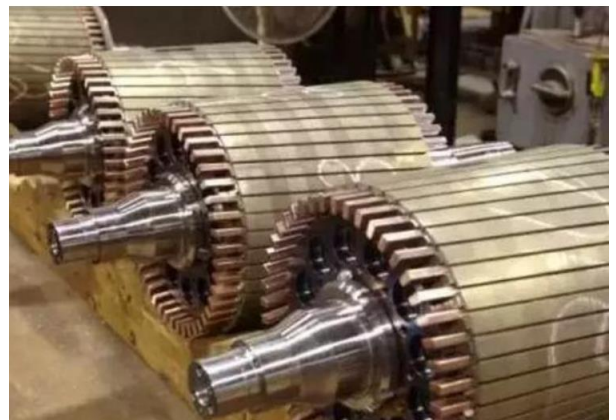
图表40: 特斯拉的纯铜转子示意图
