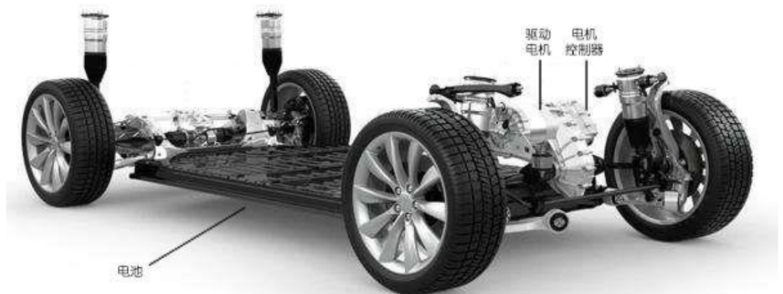
图 17: 新能源汽车电机、电控和电池示意图
