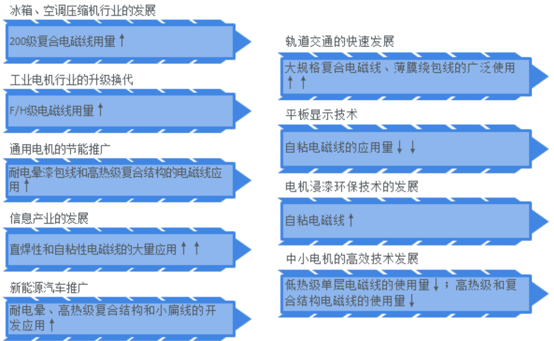
图 3: 下游需求推动电磁线多样性发展
