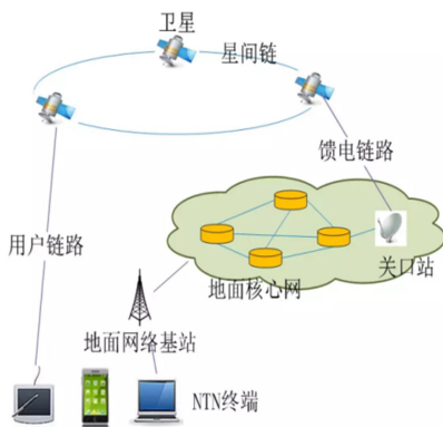
图 34 3GPP 提出的 5G 网络中非地面网络架构
