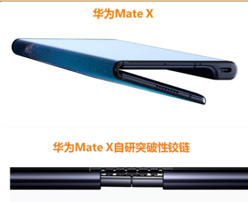
图 56：华为 Mate X 与其自研突破性铰链
