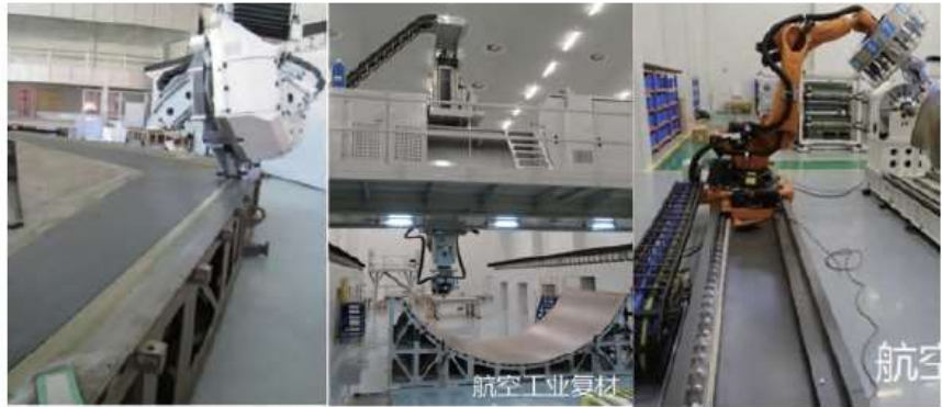
图 25: 国产桥式自动铺带机和铺丝机及机械臂式自动铺丝机实物图
