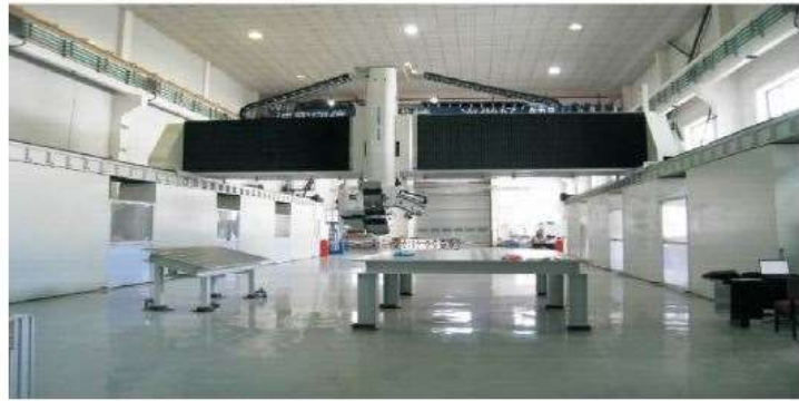
图 24: 国产大型龙门自动铺带机系统
