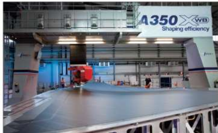
图 20: 空客 A350 机翼蒙皮自动铺带设备
