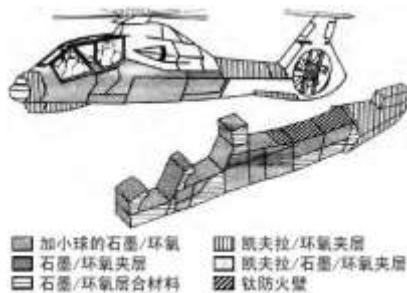
图 35: RAH-66 复合材料使用情况图示
