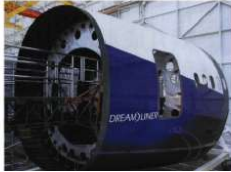
图 23：采用自动铺丝技术制造的波音 787 机身段
