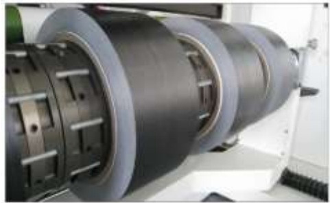
图 9: 单向碳纤维预浸料实物图
