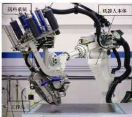
图 26: 某典型机器人自动铺丝系统实物图
