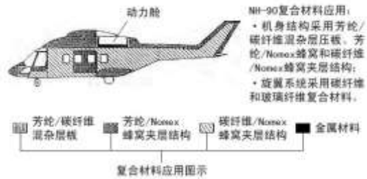
图 36: NH-90 复合材料应用情况图示
