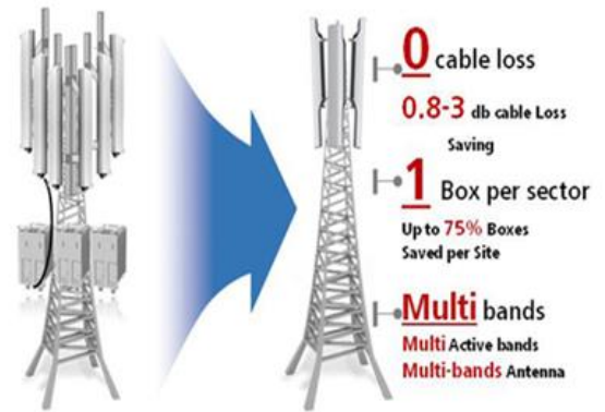
图 18:5G 天线与射频模块集成示意图
