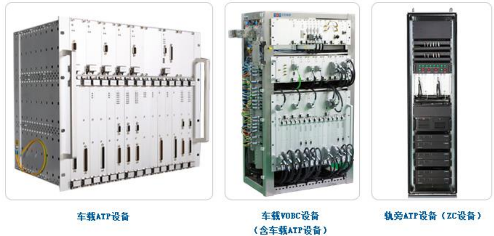
图表23：CBTC系统部分关键设备
