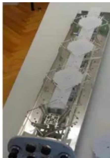
图 22：4G 多频段天线内部结构
