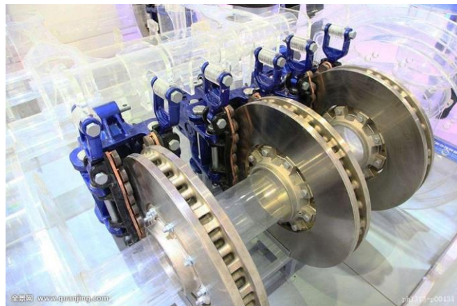
图表 15: 闸片与制动盘组成一对摩擦副
