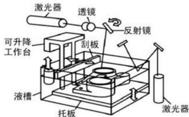
图表 9: SLA 工艺原理示意图
