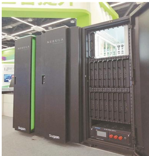
图 10：曙光使用浸没式液体相变冷却技术的硅立方
