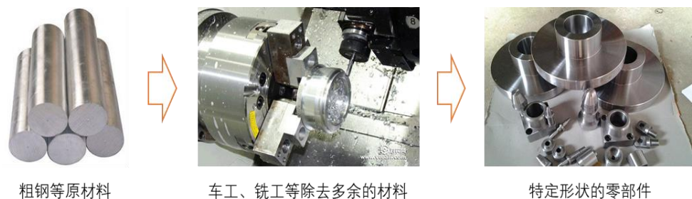
图表7 减材制造举例——通过车铣等工序将粗钢原材料加工成特定的形状
