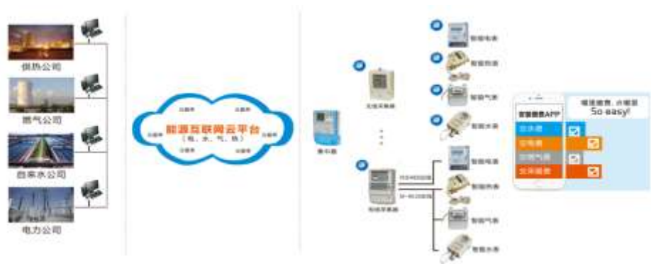
图表49： 智能四表集抄系统结构
