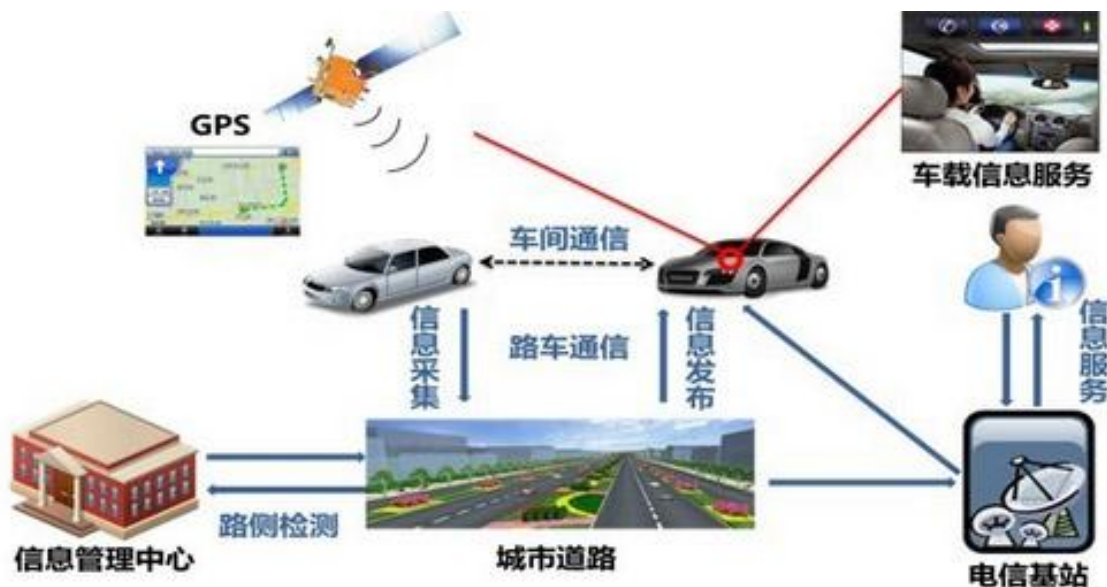
图表191： 车联网（V2X）由“端、管、云”构成，包含车内网、车际网和车载移动互联网三个层次
