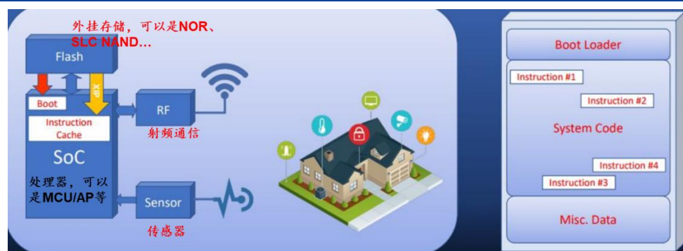
图表 21: 一个典型的物联网模块包括处理、外挂存储、射频通信以及传感器
