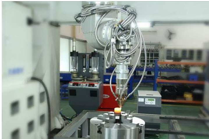
图 28: 大族激光高架龙门式三维五轴激光焊接与熔覆设备
