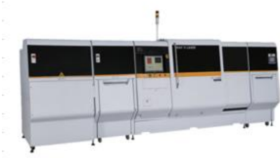
图 36：大族 CO2 双光束双台面 PCB 激光钻孔机
