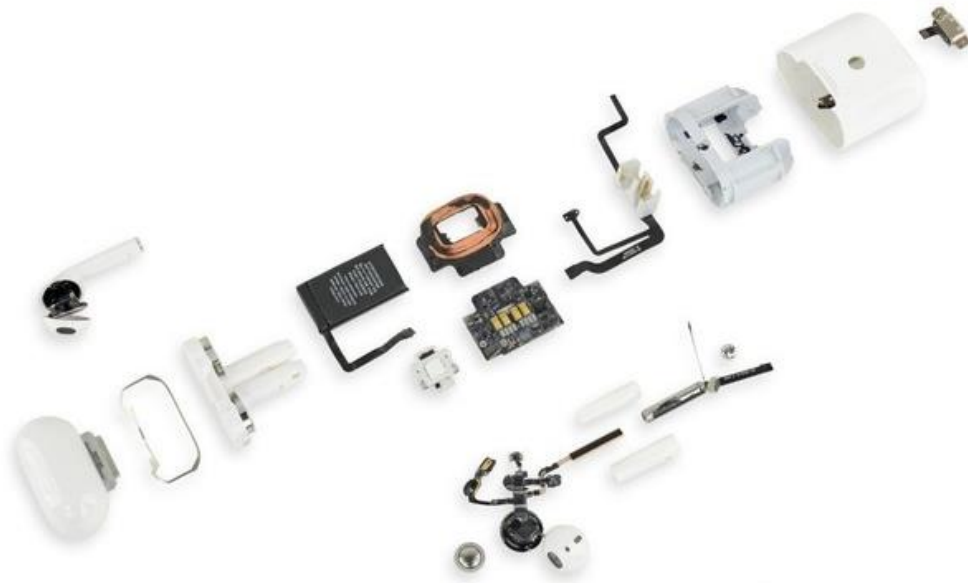
图 4 AirPods 2 完全拆解图
