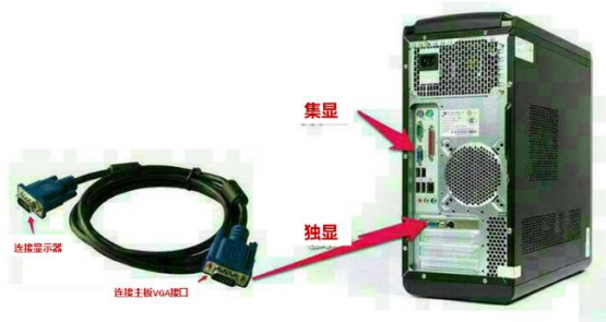
图表 30: 集成显卡和独立显卡接口
